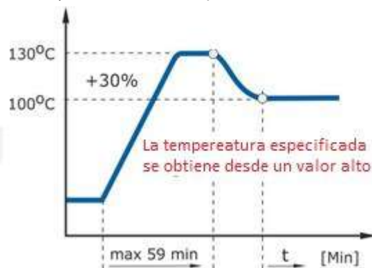
RAPIDO se aplica al secar muestras de alto contenido de humedad
