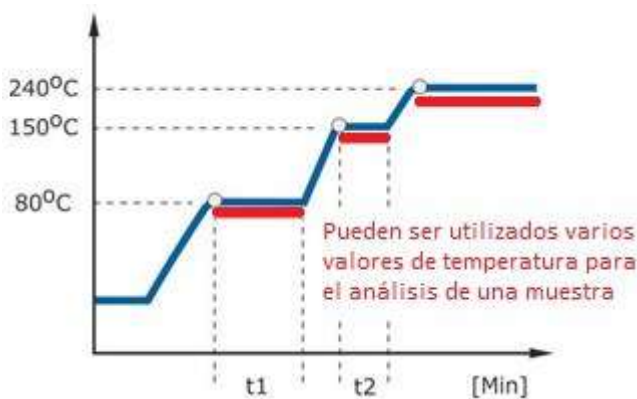
ESCALONADO es aplicable cuando se trabaja con minerales
