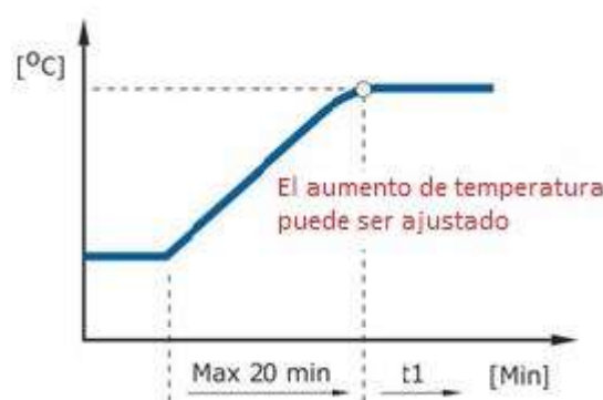
MODERADO se usa en aquellos casos en los que un aumento de temperatura demasiado rápido provoca la evaporación de otras sustancias además del agua
