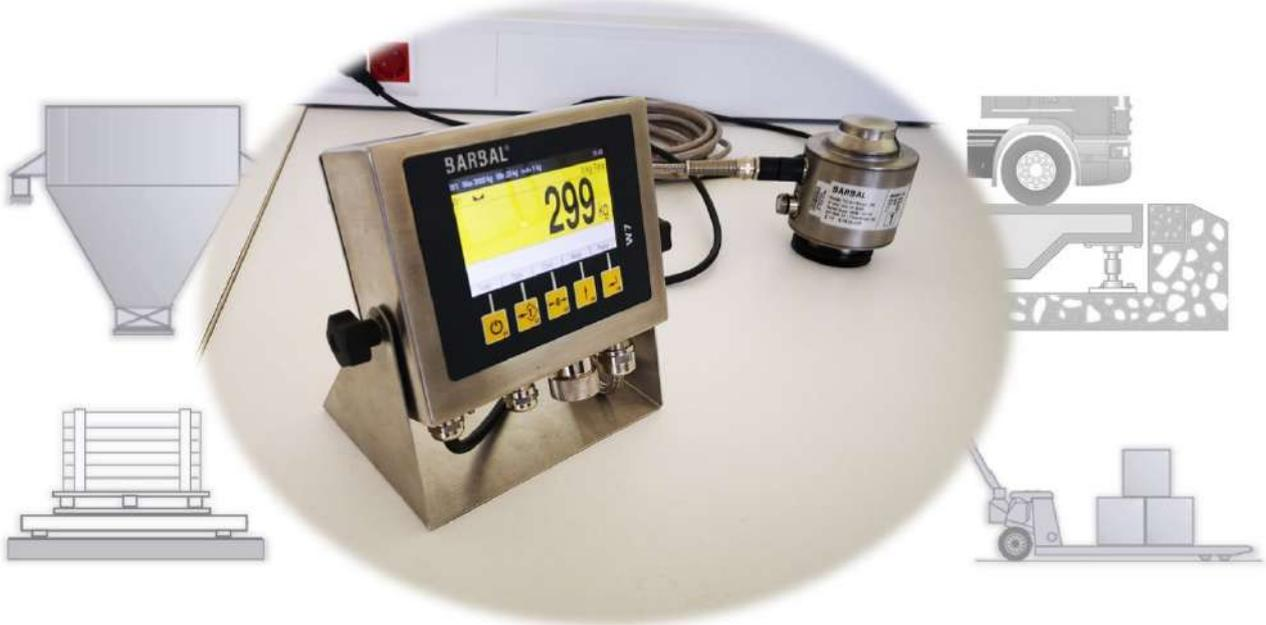
El indicador de pesaje W7 viene en acero inoxidable IP69K, es adecuado para condiciones ambientales difíciles y ubicaciones con altos estándares de higiene, como la industria alimentaria, farmacéutica, química, etc. Conecta celdas de carga analógicas y digitales TC-D. Conexión RS232 hacia impresora o PC. Opciones para PLC, Ethernet, etc. En aplicaciones de silos, puente-bascula, plataformas, etc.
